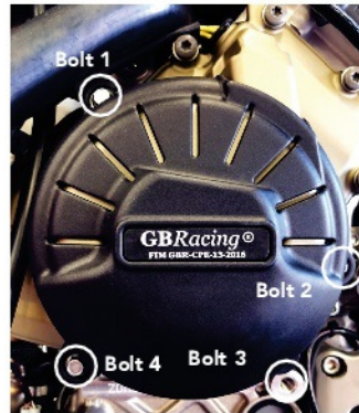
Schraube 4 M6X30TORX - 11Nm
